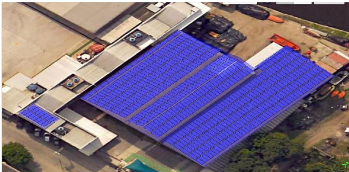
Figura 2. Dimensionamento do sistema de placas fotovoltaicas
